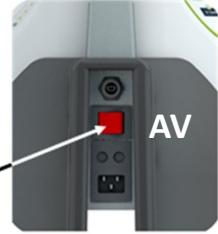
1. Koble til strømkabel, men la rød hovedbryter være slått av (lampen i rød bryter er slukket).
